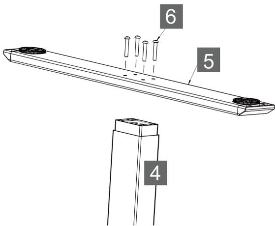
Fügen Sie an jede der beiden Hubsäule jeweils eine Kufe (5) an. Verwenden Sie dazu vier M6x35 Schrauben (6) und ziehen Sie sie kreuzweise fest.
