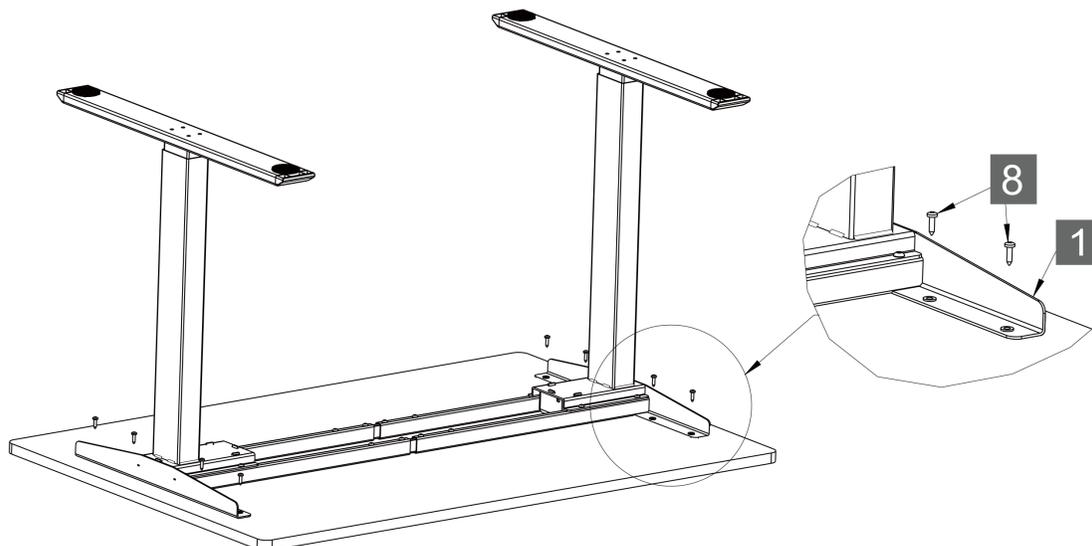
Je nach Tischplatte sind bereits vorgebohrte Löcher vorhanden. Überprüfen Sie daher beide Seiten der Platte, bevor Sie das Tischgestell auf der Unterseite der Tischplatte platzieren. Passen Sie nun die Breite des Tischgestells mithilfe der Zentral-Schienen an die jeweilige Tischplatte an.
