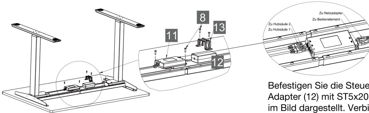
Befestigen Sie die Steuereinheit (11) und Adapter (12) mit ST5x20 Holzschrauben (8) wie im Bild dargestellt. Verbinden Sie die Kabel aus Hubsäulen und Adapter mit der Steuereinheit.
