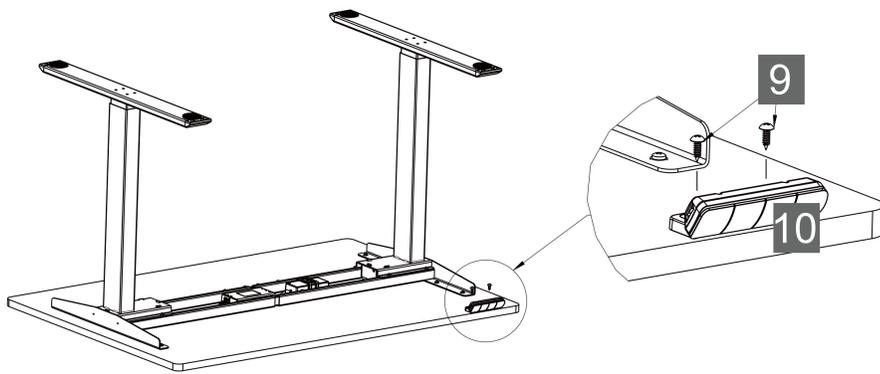
Befestigen Sie das Bedienelement (10) so, dass die Vorderseite des Elements mit der vorderen Schreibtischkante abschließt. Benutzen Sie zwei ST4.2x16 Holzschrauben (9) um das Bedienelement an der Tischplatte zu befestigen. Verbinden Sie die Kabel von Bedienelement mit Steuereinheit.
