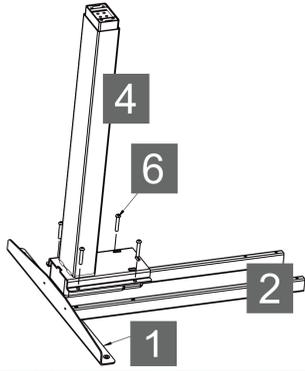
Platzieren Sie eine Hubsäule (4) im Rahmenteil (2) mit einer seitlichen Halterung (1). Richten Sie die Löcher in den drei Teilen aus. Verbinden Sie die Teile nun unter Zuhilfenahme des beiliegenden Innensechskantschlüssels und vier M6x35 Schrauben (6). Den Vorgang für die andere Hubsäule wiederholen.
