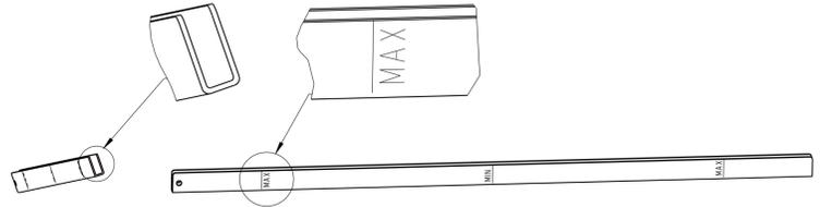
Schieben Sie die beiden Zentralschienen (3) in die beiden Rahmen (2), so dass die Öffnung der Zentralschienen (3) nach oben gerichtet ist (siehe Bildausschnitt rechts). Schrauben Sie jede Seite mit vier M6x28 Schrauben (7) fest.
